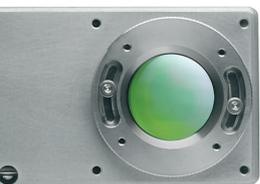
Le marquage laser se différencie de toutes les autres technologies de codage, car il a la particularité de n'utiliser aucun consommable solide ou liquide. Le marquage est réalisé au moyen d'une concentration de chaleur sur le substrat. Du dioxyde de carbone (CO<sub>2</sub>) est soumis, dans un tube scellé, à une onde de fréquence radio qui produit un faisceau laser.
