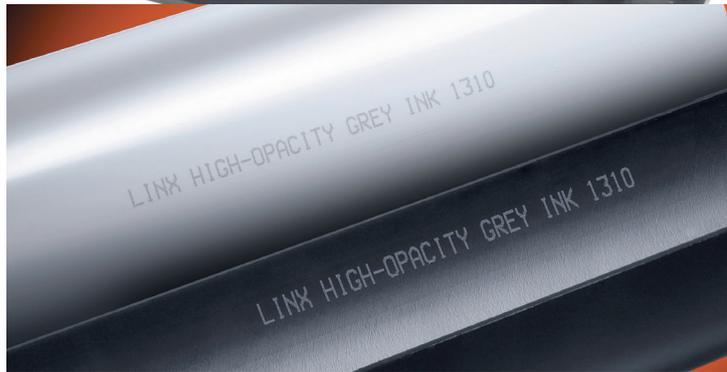
de sous-câbles marqués, en proposant, durant la même phase de production, un marquage à la demande des sous-câbles suivi du marquage de la gaine principale du câble multifilaire. L'entreprise devient donc réactive aux commandes et compétitive grâce à une baisse drastique du temps de fabrication, du nombre de manipulations des stocks (pas de rupture de stocks, s'ils existent) et des coûts de fabrication.
