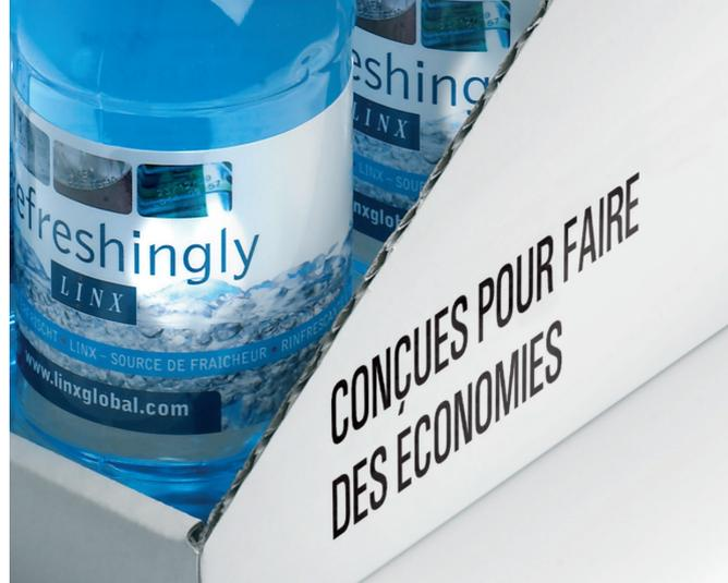
Le marquage Haute Résolution est utilisé pour identifier des emballages secondaires ou des unités logistiques en production à des fins de traçabilité ou de personnalisation. Il permet, en temps réel sur la ligne de production, d'imprimer des messages comportant de grands caractères tels que du texte, des logos, des graphiques, des codes-barres, 2D ou QR code.
